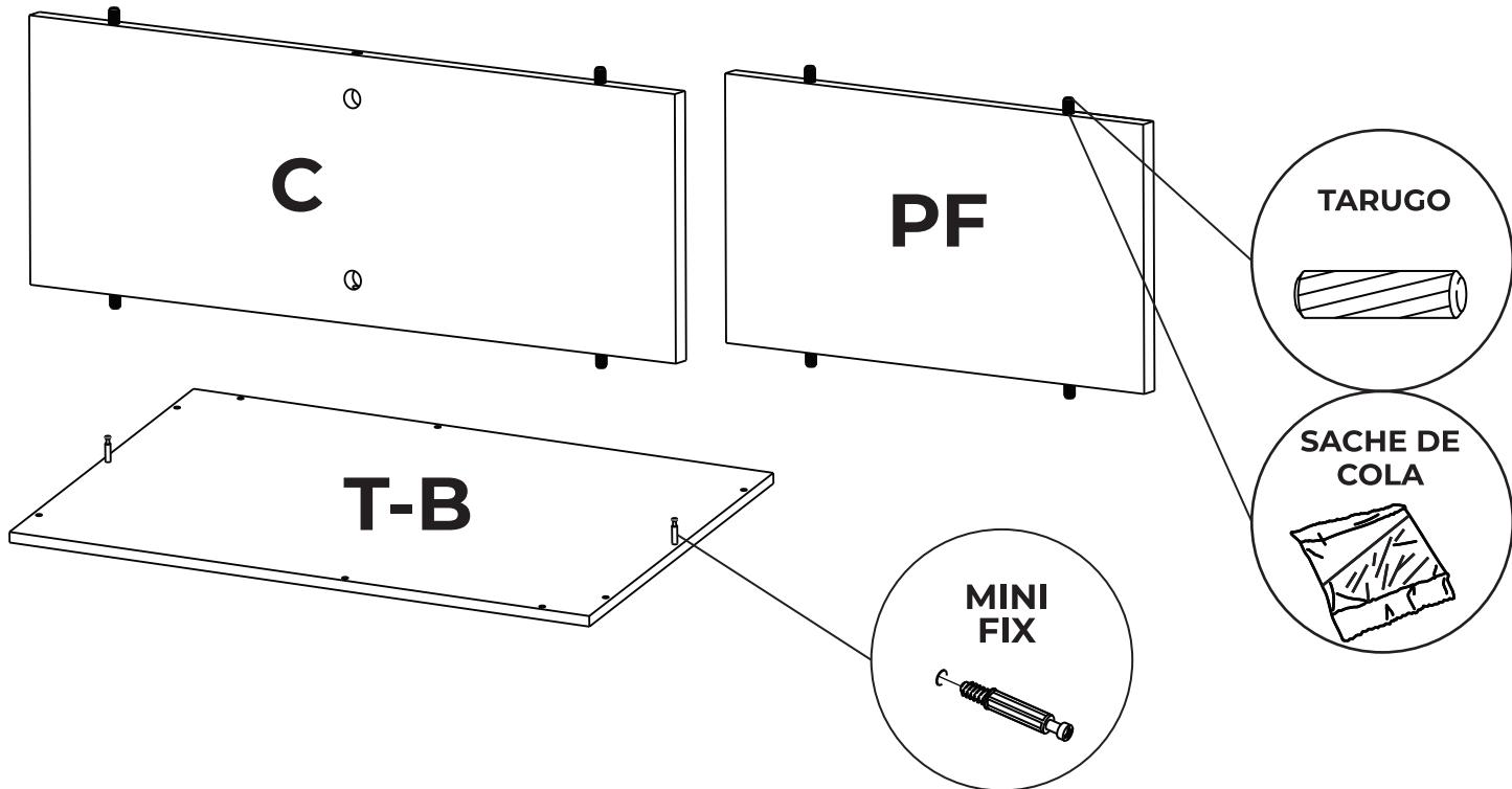
**2** Armar la estructura del mueble uniendo las piezas como se muestra a continuacion. Colocar la cazoleta para ajustar el tornillo mini fix. Previamente haber encolado los agujeros que alojan los tarugos.
